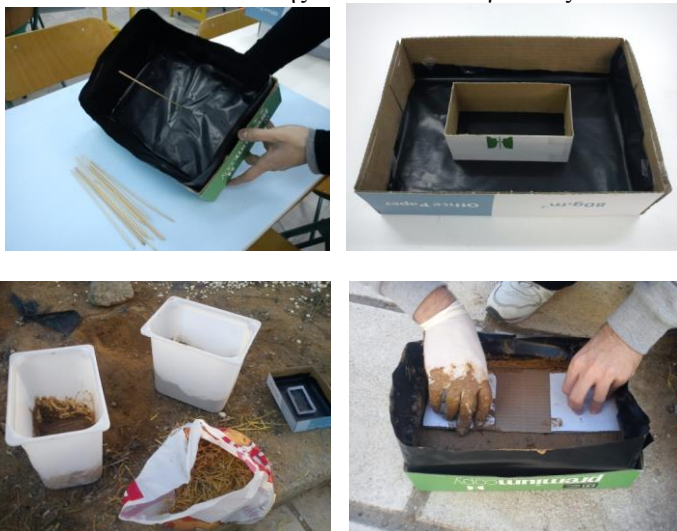
Σχήμα 10 : Η διαδικασία κατασκευής των καλουπιών για τους πλίνθινους τοίχους
