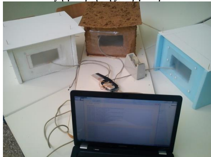
Σχήμα 9 : Η διάταξη μέτρησης θερμοκρασιών των σπιτιών
