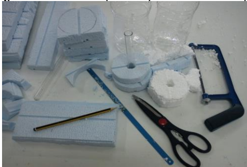
Σχήμα 4 : Κατασκευή κυλίνδρων από πολυστερίνη
