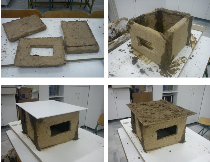
Σχήμα 11 : Στάδια κατασκευής του πλίνθινου σπιτιού
